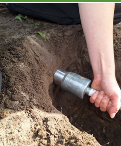
Het nemen van monsters op 5 en 25 cm onder maaiveld, om bodemdichtheid en bodem waterhoudend vermogen te analyseren
