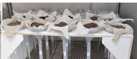
Trechter opstelling voor het verzamelen van potwormen uit verse bodemonsters
