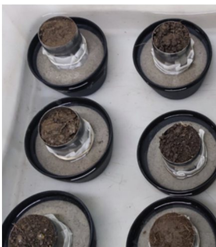
Opstelling waardoor middels capillaire werking water wordt opgenomen in de intacte bodemonsters voor waterhoudend vermogen
